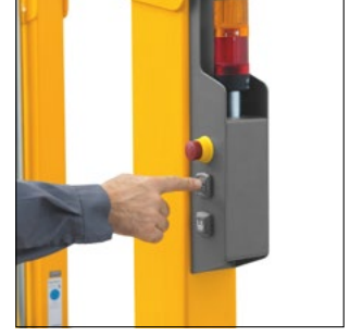
Tuşlar vasıtasıyla ergonomik yükseklikte kaldırma ve indirme.
